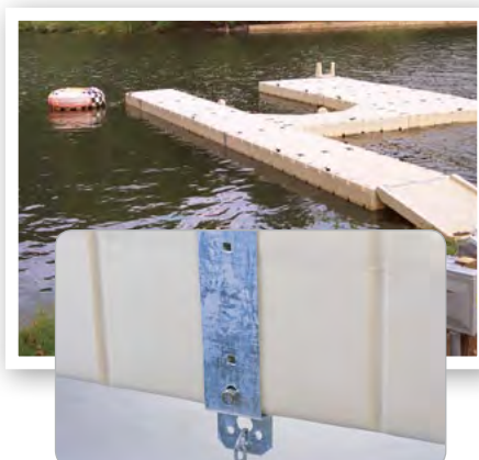
Držák mrtvé váhy (standard) Č. dílu 100740 nebo 100740SS Pro ukotvení mola za pomoci závaží mrtvé váhy. Řetěz a závaží se prodávají samostatně. Prodává se v páru.
